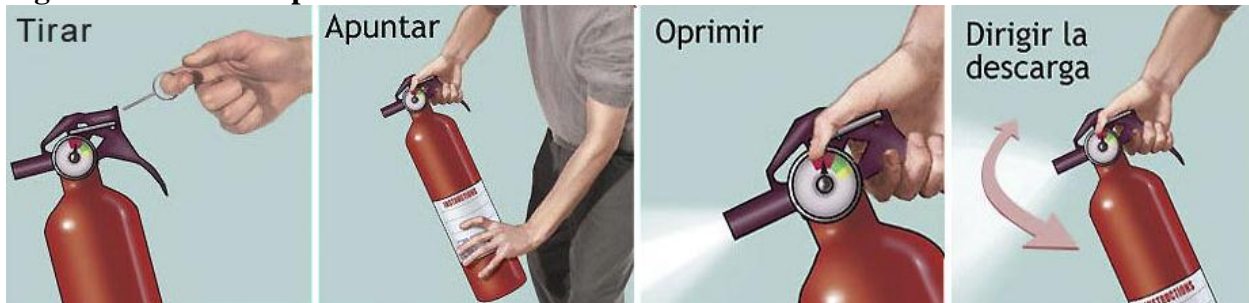
Figura 3. Modo de Operación de extintores
