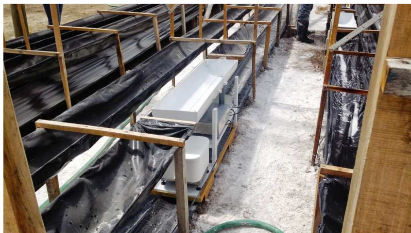
Figura 2-5: Instalación del Lisímetro de pesada en las camas donde se siembra clavel.
