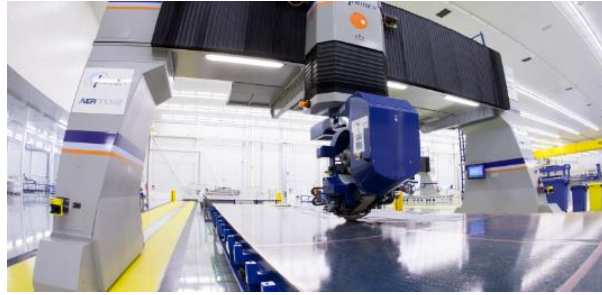
Ilustración 8. Automated Tape Lay-Up. Esta máquina permite la posibilidad de laminar y cortar, refuerzos, pieles costillas y largueros.
