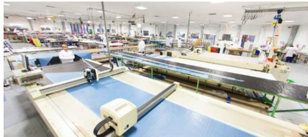
Ilustración 9 Hand Lay-Up utilizada para piezas monolíticas de productos aeronáuticos como de otros sectores industriales.
