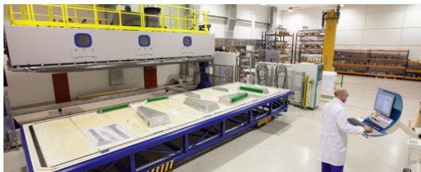
Ilustración 10 RTM e Infusión. Permite trabajar preformas de fibras en seco, lo cual posibilita las propiedades mecánicas del material.
