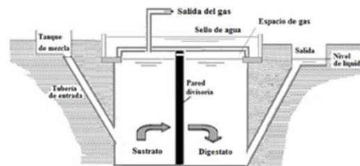
Ilustración 6. Esquema general de un biodigestor híbrido cubano
