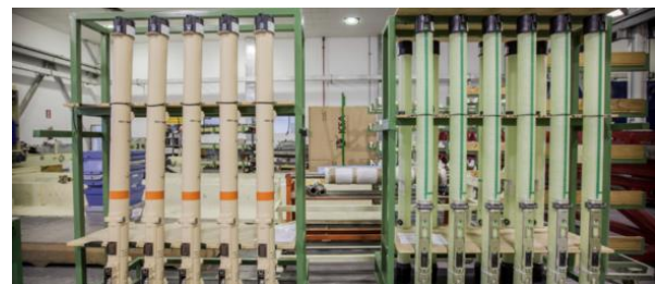
Ilustración 11 Filament Winding. Tiene la capacidad del cabezal de la máquina que permite fabricar piezas de revolución con formas complejas.
