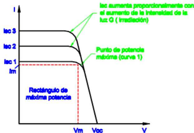
Figura 8. Curva normal I-V como una función de la intensidad de la radiación G_1 < G_2 < G_3 (Unidad: kW/m 2 )
