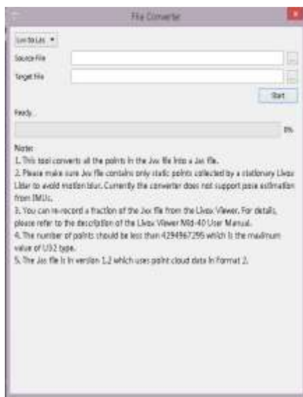
Figura 8. Convertidor de formato lvx a las
