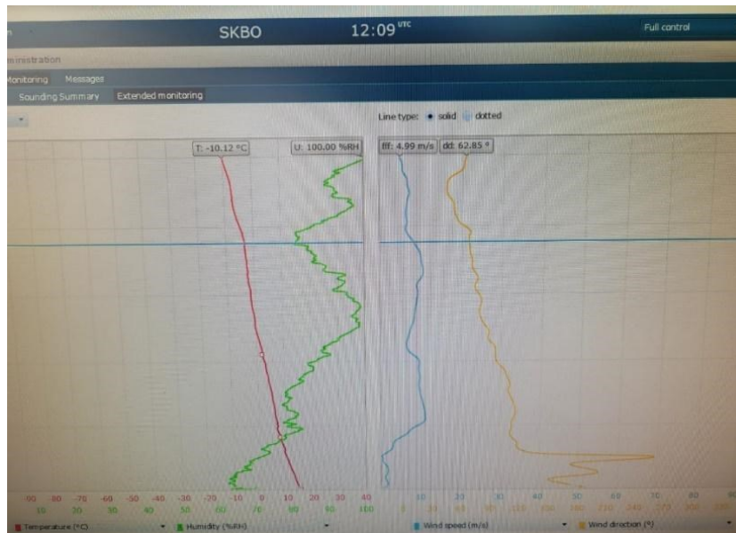
Figura 55. Dato de radiosonda para verificación de Isoterma (Elaboración propia)
