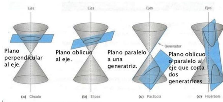
Figura 11. Obtención de las secciones cónicas en el cono de Apolonio y cortes del plano con respecto al eje.
