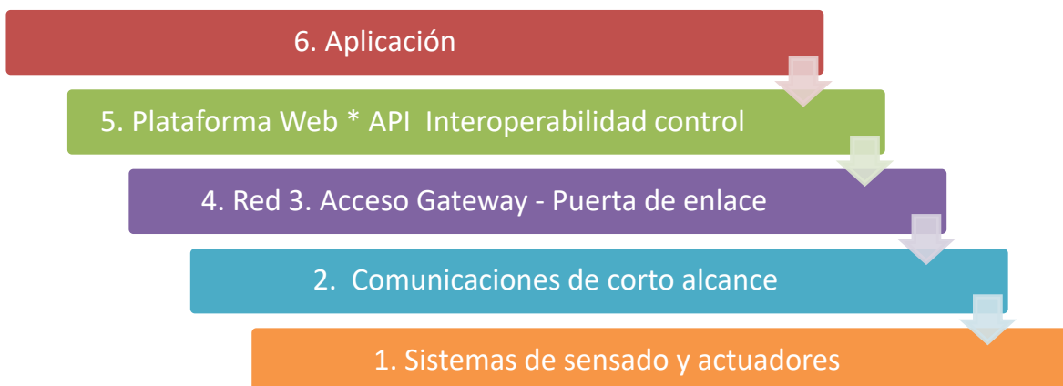
Figura 3. Modelo por capas propuesto para los sistemas IoT
