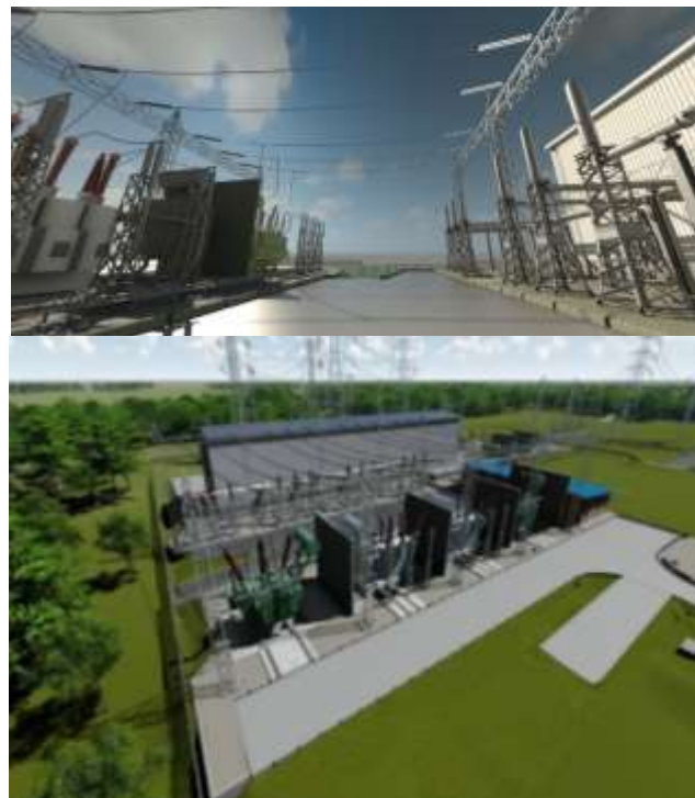
Figura 15 Modelo Bim de la subestación eléctrica
