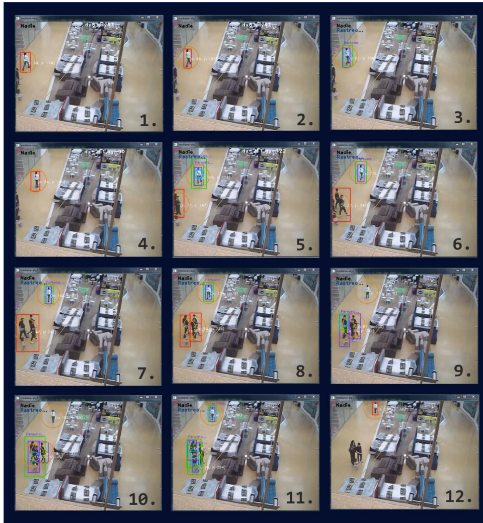
Figura 38. Detección y tracking de personas por el prototipo del sistema. Fuente imagen propia
