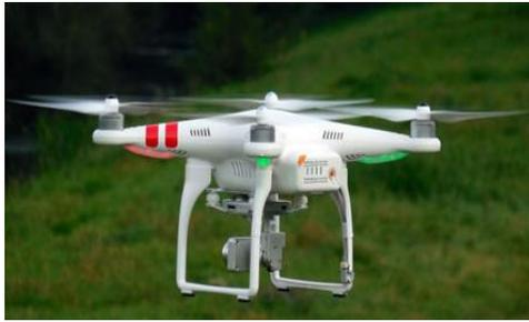
*Ilustración 2. RPAS ala rotatoria Phantom 3. Fuente: (EMBENTION, 2016)*
