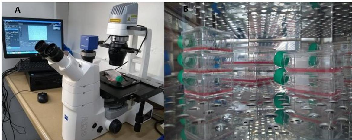
**Figura 10.** A. Monitoreo del cultivo celular mediante el microscopio de lente invertido Seizz AX10 y el software Zeiss Zen 2.6 lite. B. Cajas T25 de cultivo celular en atmosfera húmeda con 5% de CO<sub>2</sub> en la incubadora HeraCell Vios 160i (Thermo Fisher Scientific, DE, USA).
