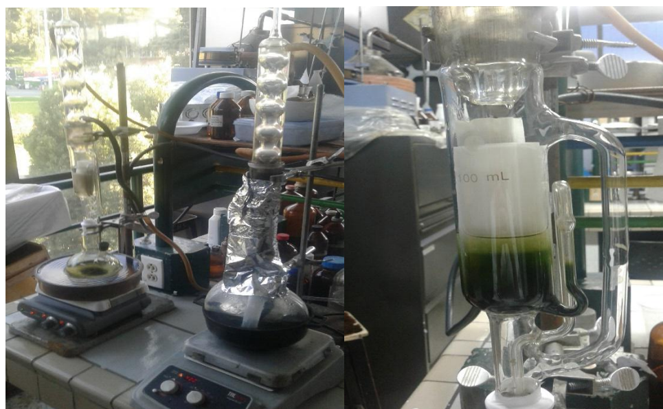
Figura 22. Extracción de metabolitos secundarios presente en la especie Coronopus Didymus empleado el equipo Soxlet.
