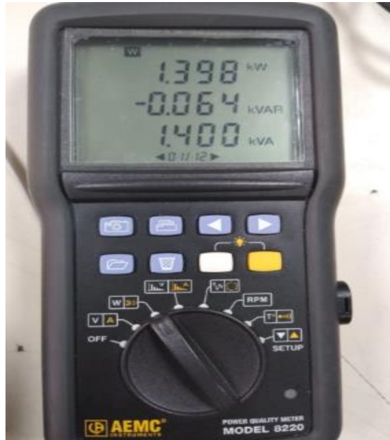
Ilustración 54 Medida de Potencias del prototipo con Vatímetro AEMC 8220
