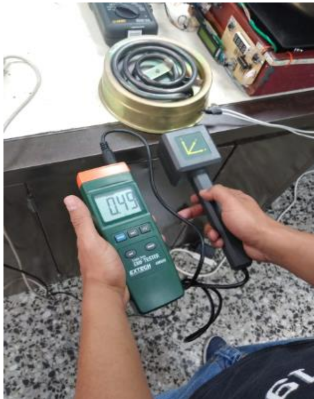
Ilustración 58 Medición de campo Cocina eléctrica de resistencia
