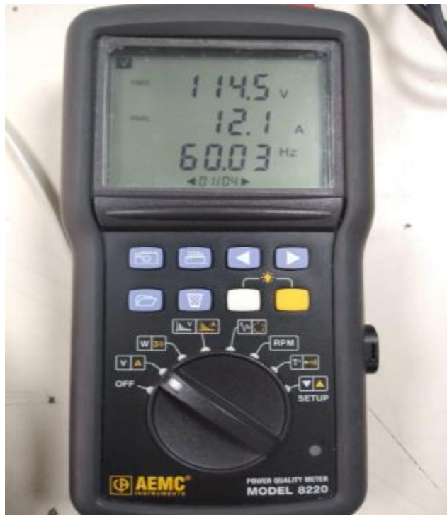
Ilustración 54 Medida de Potencias del prototipo con Vatímetro AEMC 8220
