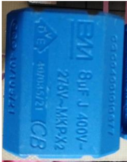
Ilustración 37 Condensador de 8uF para Filtro (Fuente elaboración propia)
