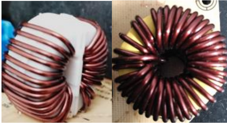
Ilustración 38 Bobina de para el filtrado de armónicos (Fuente elaboración propia)
