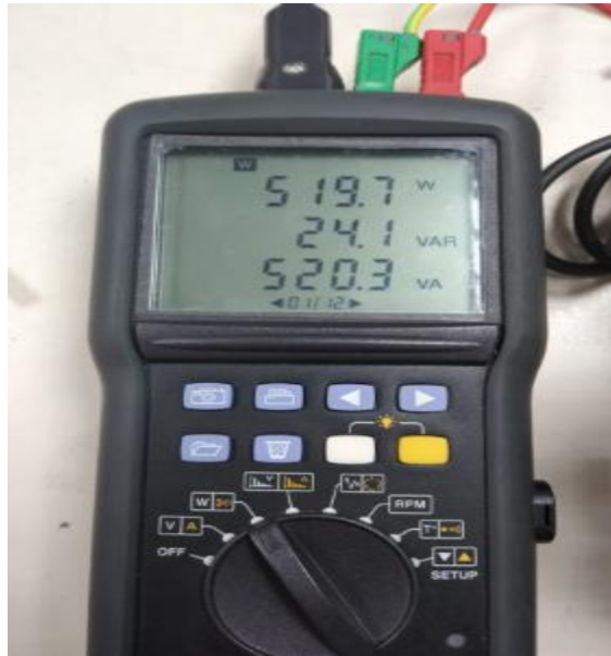
Ilustración 56 Medida de Potencias de la cocina eléctrica de resistencia con Vatímetro AEMC 8220
