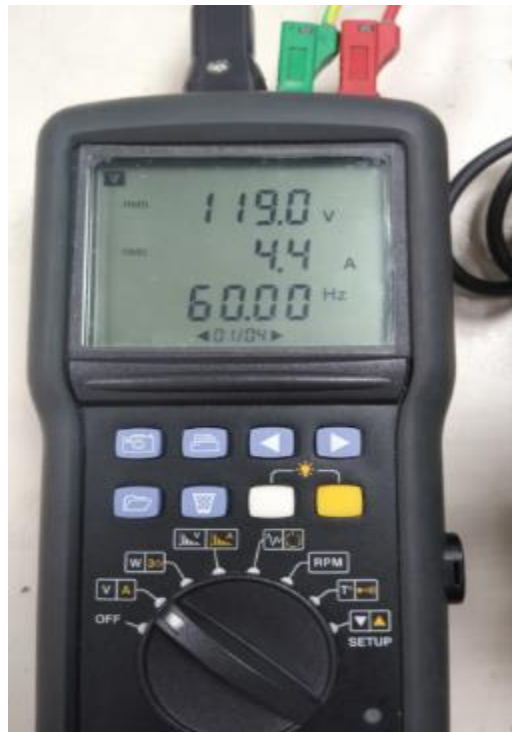
Ilustración 56 Medida de Potencias de la cocina eléctrica de resistencia con Vatímetro AEMC 8220
