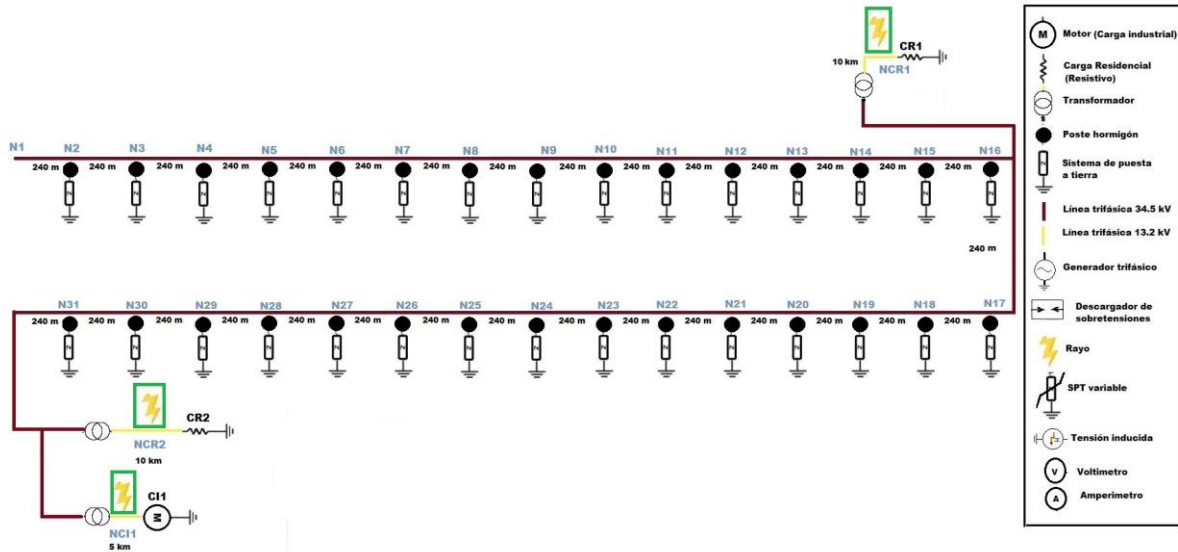
Figura 5.4. Circuito de única descarga impacto sobre las fases de la línea de 13.2 kV.
