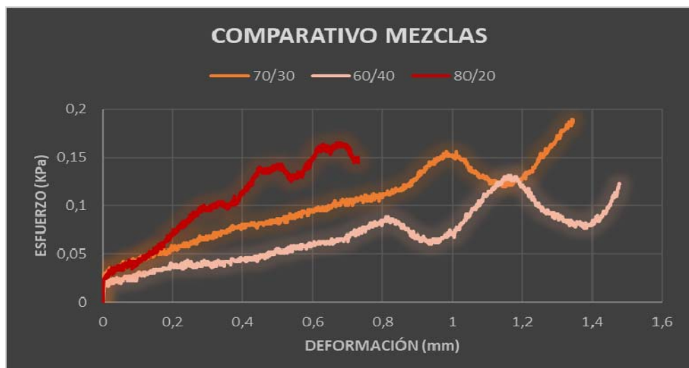
Grafica (1) comparativo mezclas 60/40 70/30 80/20 ensayo de flexión (Fuente: Autores proyecto)
