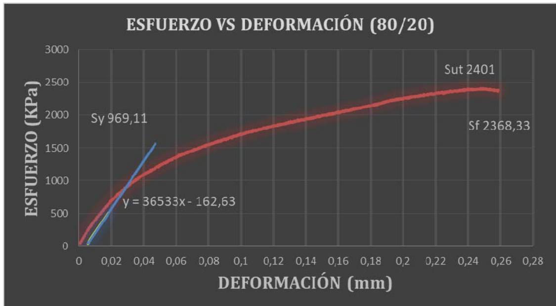
Grafica (4) Esfuerzo deformación mezcla 80/20 (Fuente: Autores proyecto)
