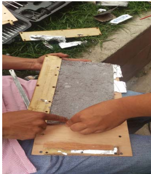
Imagen (10). Desmoldeo probetas flexión. (Fuente: autores proyecto)
