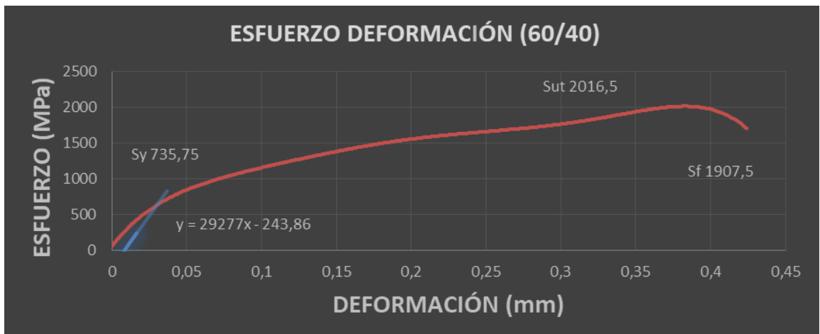
Grafica (2) Esfuerzo deformación para mezcla 60/40 (Fuente: Autores proyecto)
