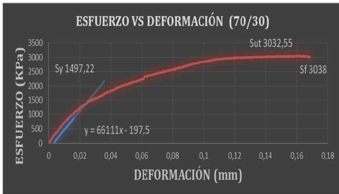
Grafica (3) esfuerzo deformación para mezcla 70/30 (Fuente: Autores proyecto)
