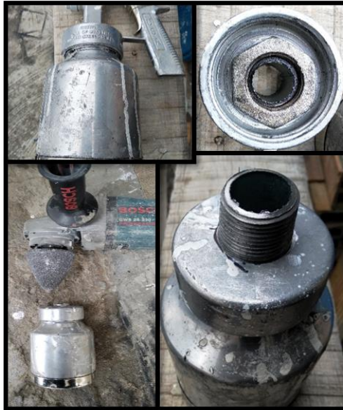
Figura 28. Fabricación del tanque de alivio
