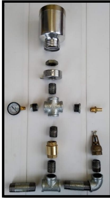
Figura 33. Componentes ensamble bomba de ariete
