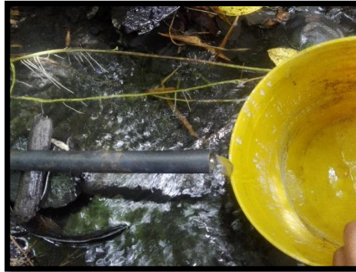
Figura 21. Toma experimental caudal entregado por el pozo
