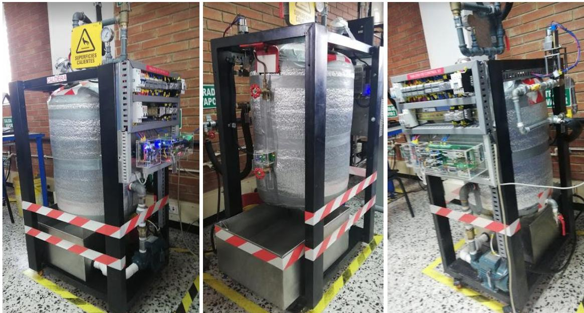
Fig 91. Estructura Física final de la Caldera. [Autor]
