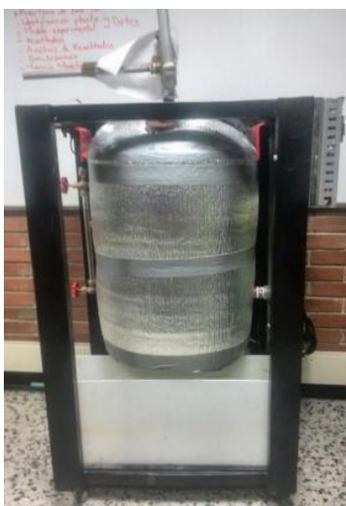
Fig 1. Caldera del proceso de pasteurización de la Universidad Distrital. [1]
