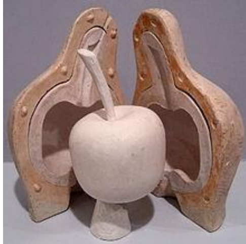
Figura 2 [3] : Modelo elaborado en escayola con un molde bivalvo.
