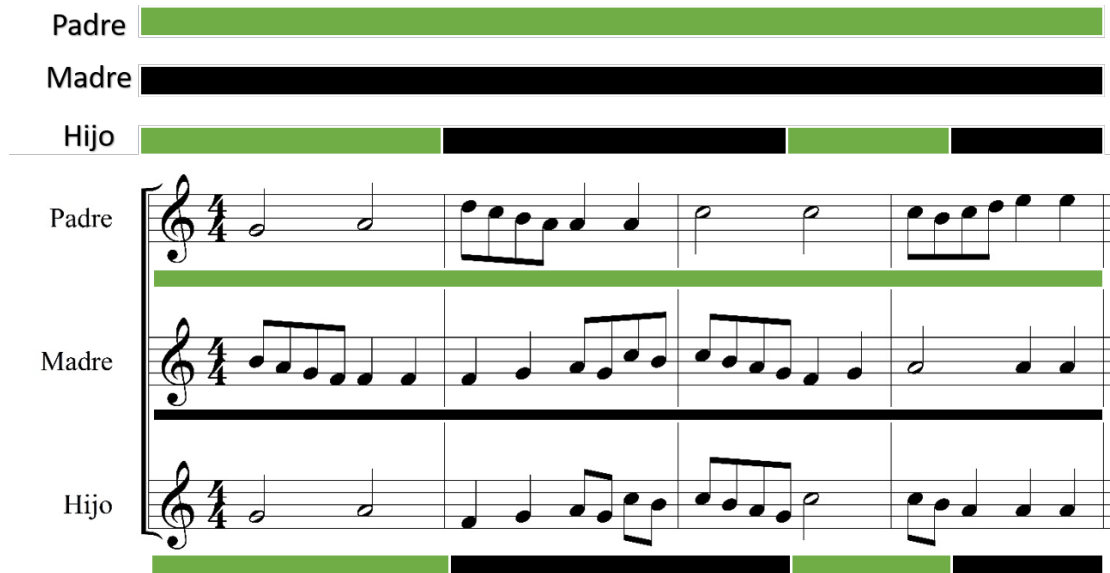
Figura 1.7: Recombinación (cruce de tres puntos) entre dos genomas, la línea verde representa el genoma del padre, la línea negra el genoma de la madre. Al realizar una recombinación de tres puntos el hijo contiene información de la madre y del padre tal como lo ilustra la imagen. Elaboración propia
