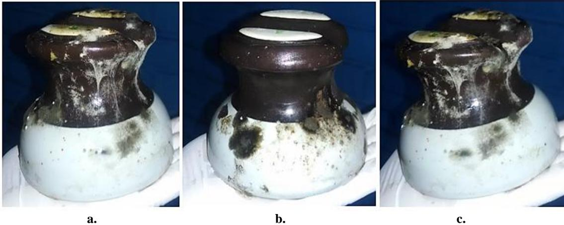
**Figura 4.9 Aisladores cerámicos tipo Pin con crecimiento de *Phanerochaete Chrysosporium*: (a) Aislador 1, (b) Aislador 2, (c) Aislador 3**
