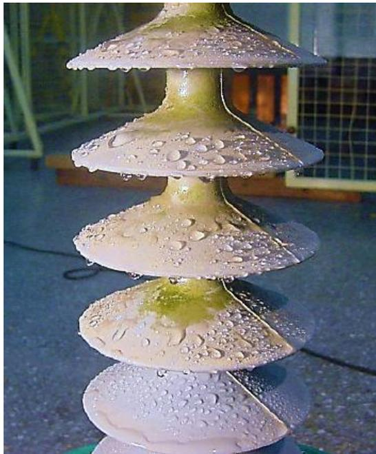
**Figura 2.7 Aislador polimérico cubierto de algas**
