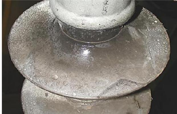
**Figura 2.5 Aislador polimérico cubierto de hollín**
