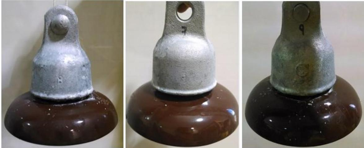
**Figura 4.13** Aisladores cerámicos tipo suspensión con crecimiento de *Chlorella Vulgaris*: (a) Aislador 8, (b) Aislador 7, (c) Aislador 9
