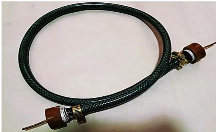
**Figura 5.6 Dispositivo para la medición de resistividad del agua**
