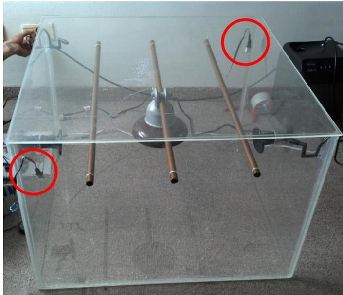
**Figura 3.4** Disposición de sensores al interior de la CAC
