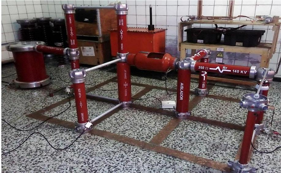
**Figura 5.8 Circuito para el ensayo de flameo al impulso tipo rayo**
