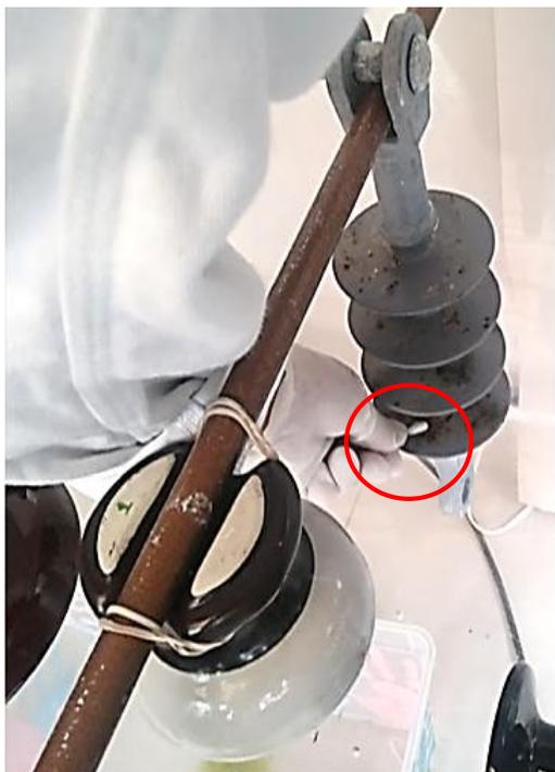
**Figura 4.14** Método de contacto con escobillón aplicado a aisladores contaminados
