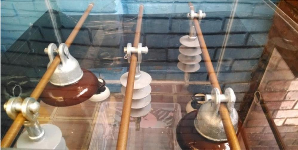
**Figura 4.1** Cámara de ambiente controlado con aisladores esterilizados en su interior
