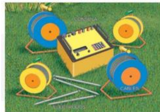
Figura 10: Instrumentos para mediciones geo electromagnéticas (Resistividad), imagen adaptada desde (ANH 2009)
