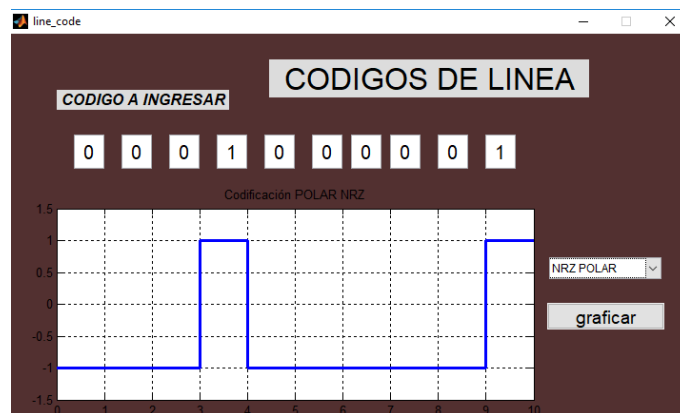
Figura 23: Codificación no retorno a cero polar.
