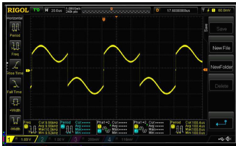
Figura 18: Reconstrucción de señal mediante el osciloscopio.
