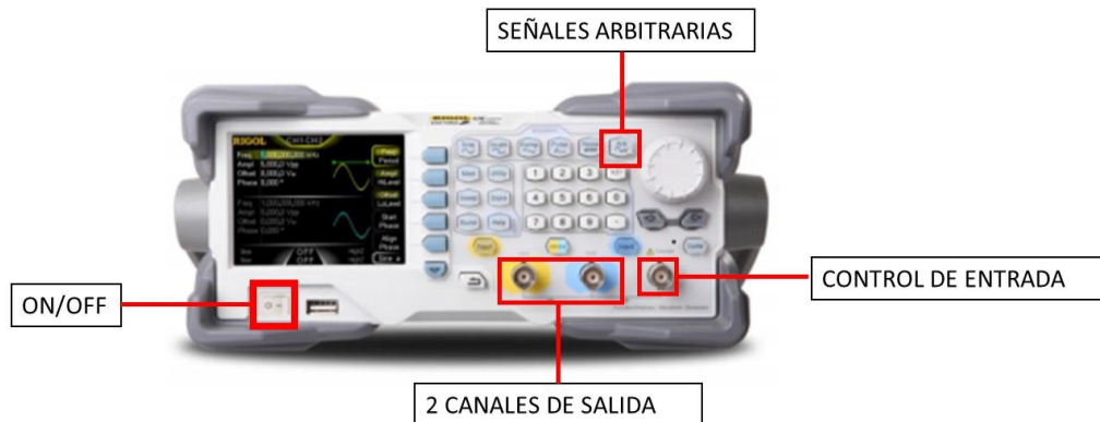
Figura 3: Características físicas DG1022Z[6].
