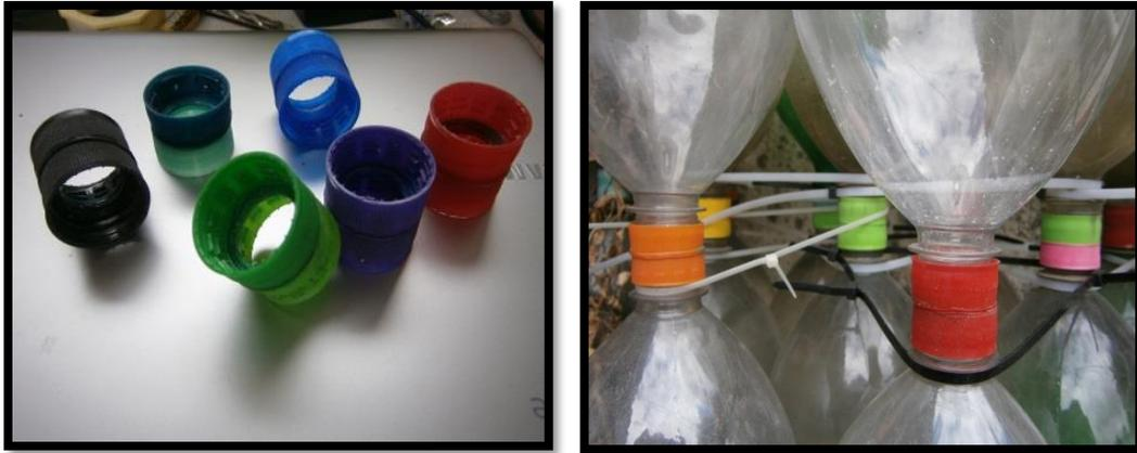
*Ilustración 13 Perforación y termofusión tapas en polipropileno. Fuente: Autor*
